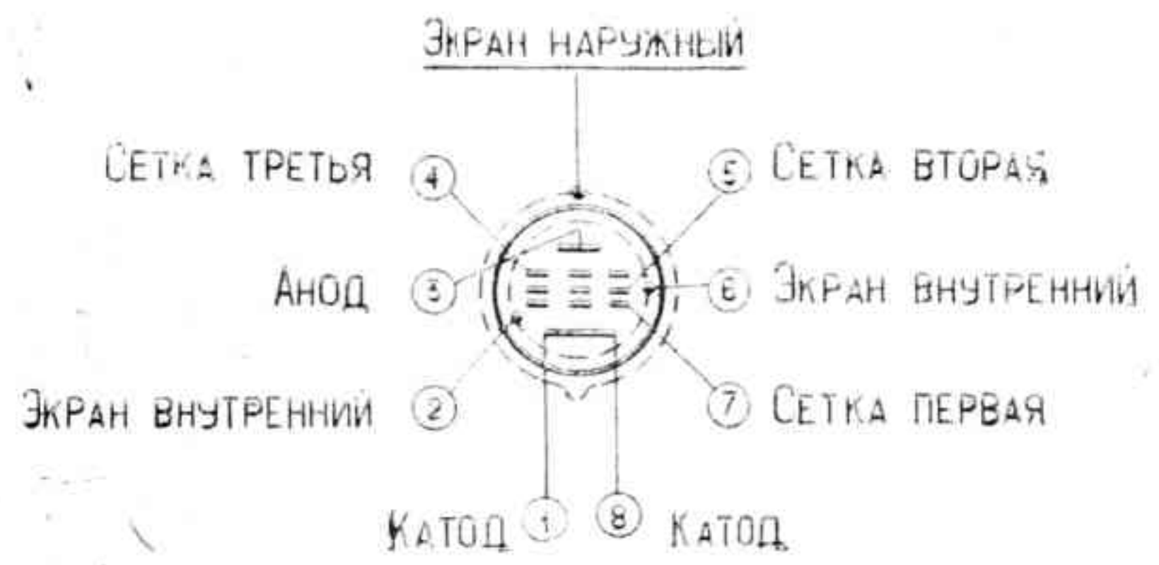
ЦОКОЛЕВКА ЛАМПЫ 2Ж27Л (Вид на цоколя сзади)
